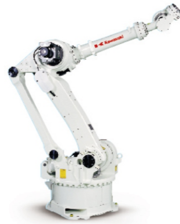
大型通用机器人~300kg负载
