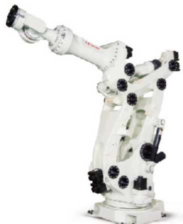
超大型通用机器人~1,500kg负载
